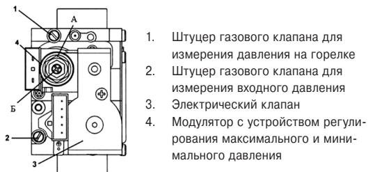
Рис. 10. Газовый клапан SIT 845 Sigma.
